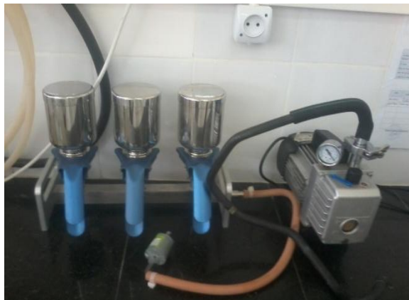
Pompe de filtration
