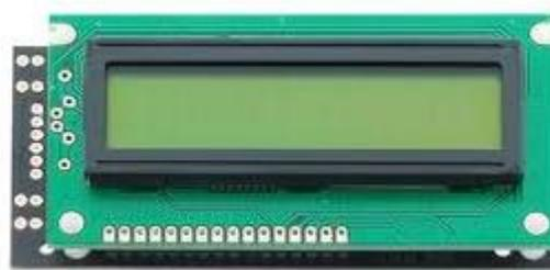
Figure2.6. Afficheur LCD
