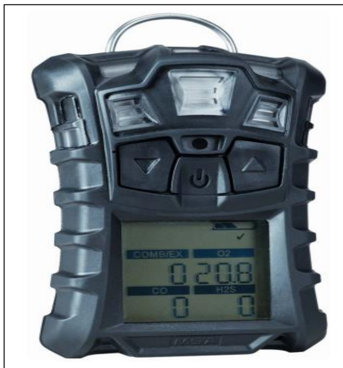
Photo III.5- Détecteur de gaz de type "ALTAIR 4"
