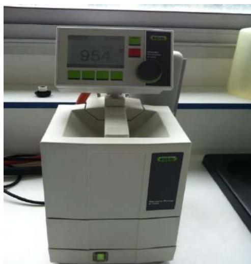
Figure 31 : Le rotavapor P-12 connecté à la pompe à vide V-700.
