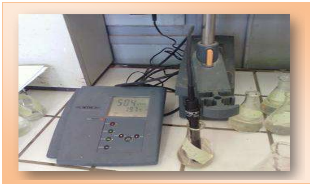
Photo .3 : Mesure de la conductivité électrique (CE) du sol
