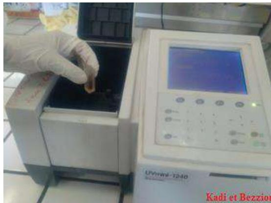
**Photo 22.** Mesuré de la densité optique par un spectrophotomètre
