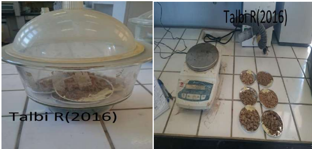
Photo.8. Mesure de l'humidité
