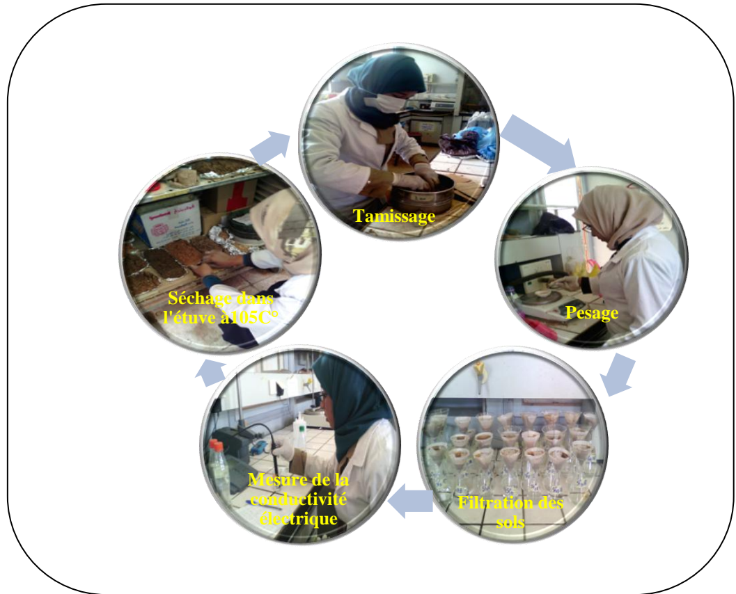
Figure 14 : Mesure de la condevtivité électrique
