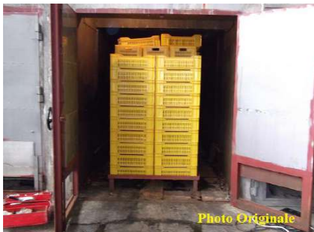
Fig. 33 : Bacs de dattes dans un tunnel de réhumidification (usine 01).
