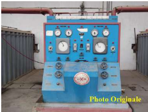
Fig. 23 : Régulateur du triple Tps/P/T° de la chambre de stérilisation (Usine 02, 2016)
