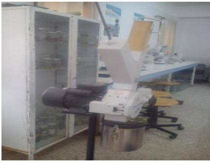
Photo. 24 - Broyeur électrique
