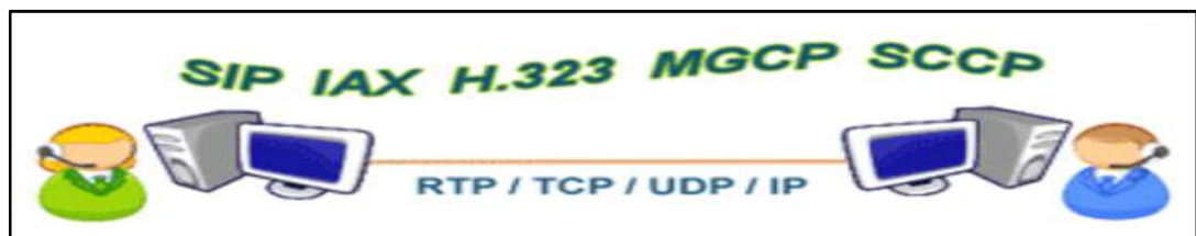
Figure 2.3: Les protocoles de la VoIP
