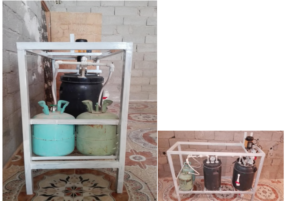
Figure IV.5 et 6 digesteur avec d'autre face
