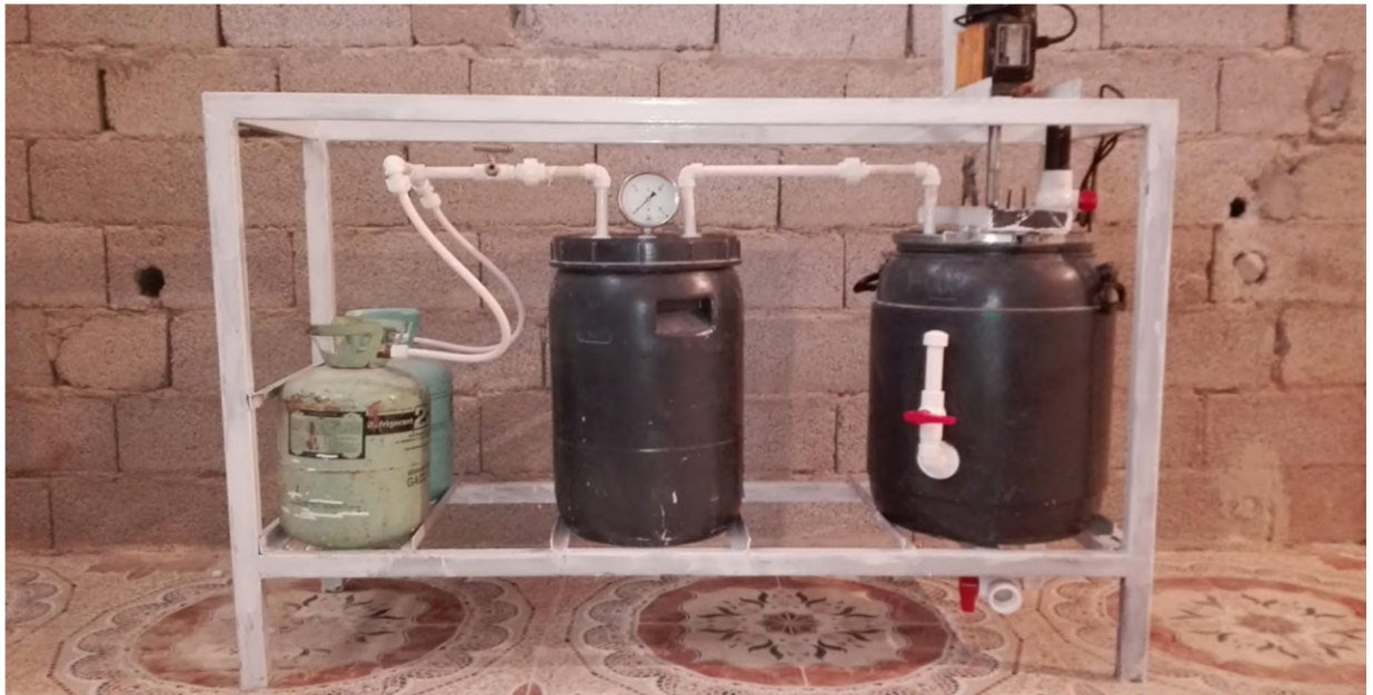
Figure IV.4: Digesteur pédagogique du biogaz
