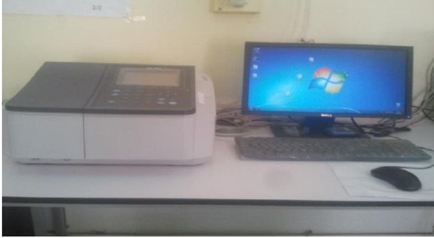
شكل(III.3): جهاز الأشعة فوق بنفسجية في المجال المرئي الموجود في مخبر (VTRS)
