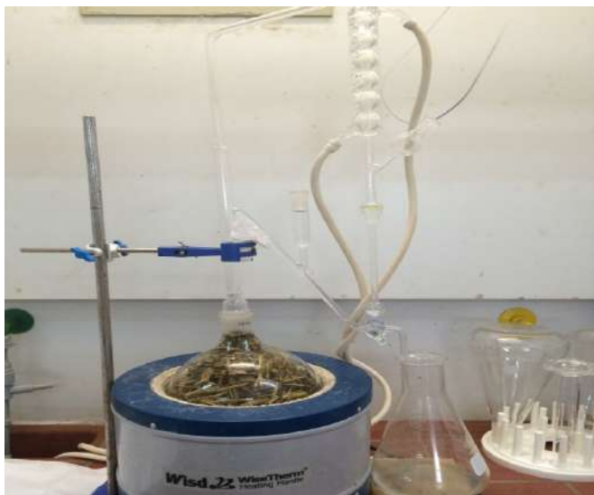
Figure.18 : dispositif de l'hydrodistillation par Clevenger
