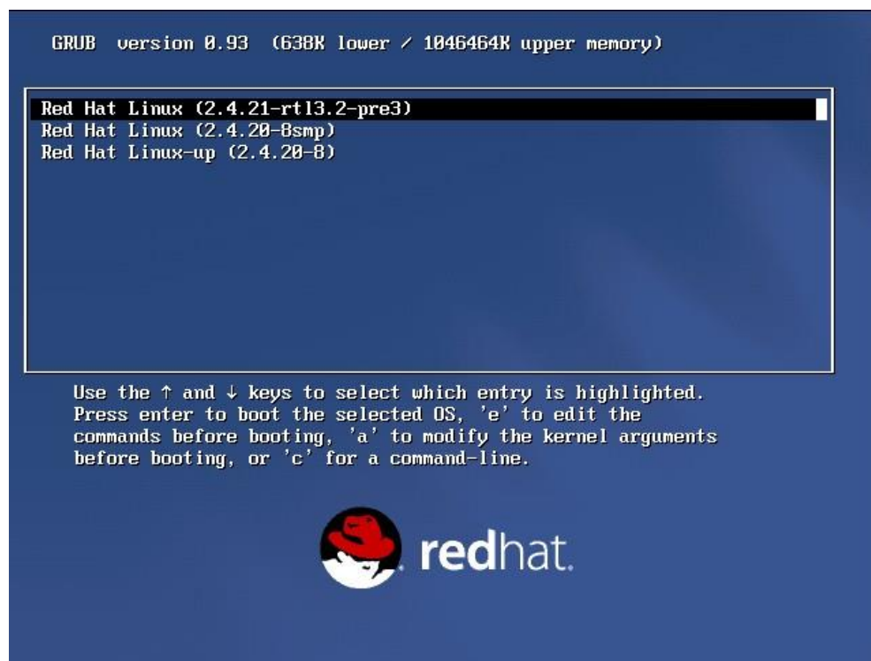
Figure 4.2 – Capture d'écran qui présente le Dual boot de Linux et RTLinux
