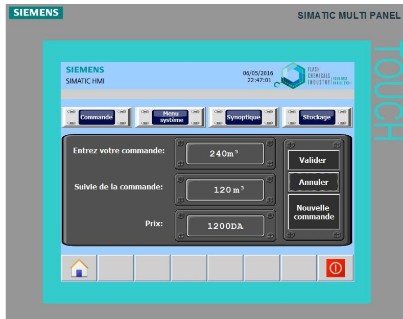
Figure 67 : Interruption de la commande à partir de l'écran de commande de l'HMI
