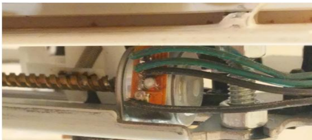
Figure IV.7: Souder les fils au niveau du moteur
