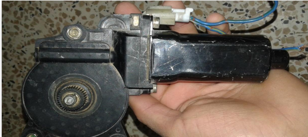
Figure (II.12) : Moteur à courant continu utilisé dans ce projet
