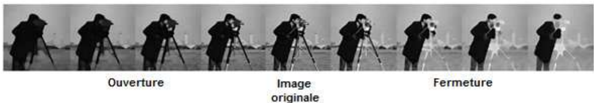
Figure 2.7 : Comparaison entre fermeture et ouverture.
