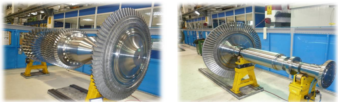
Fig. I.7 : Turbines HP & BP.
