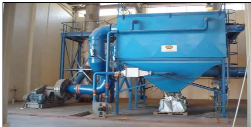
Fig. I.7 : Filtre, absorbeur et cheminée Modèle ATI-HP 2008.
