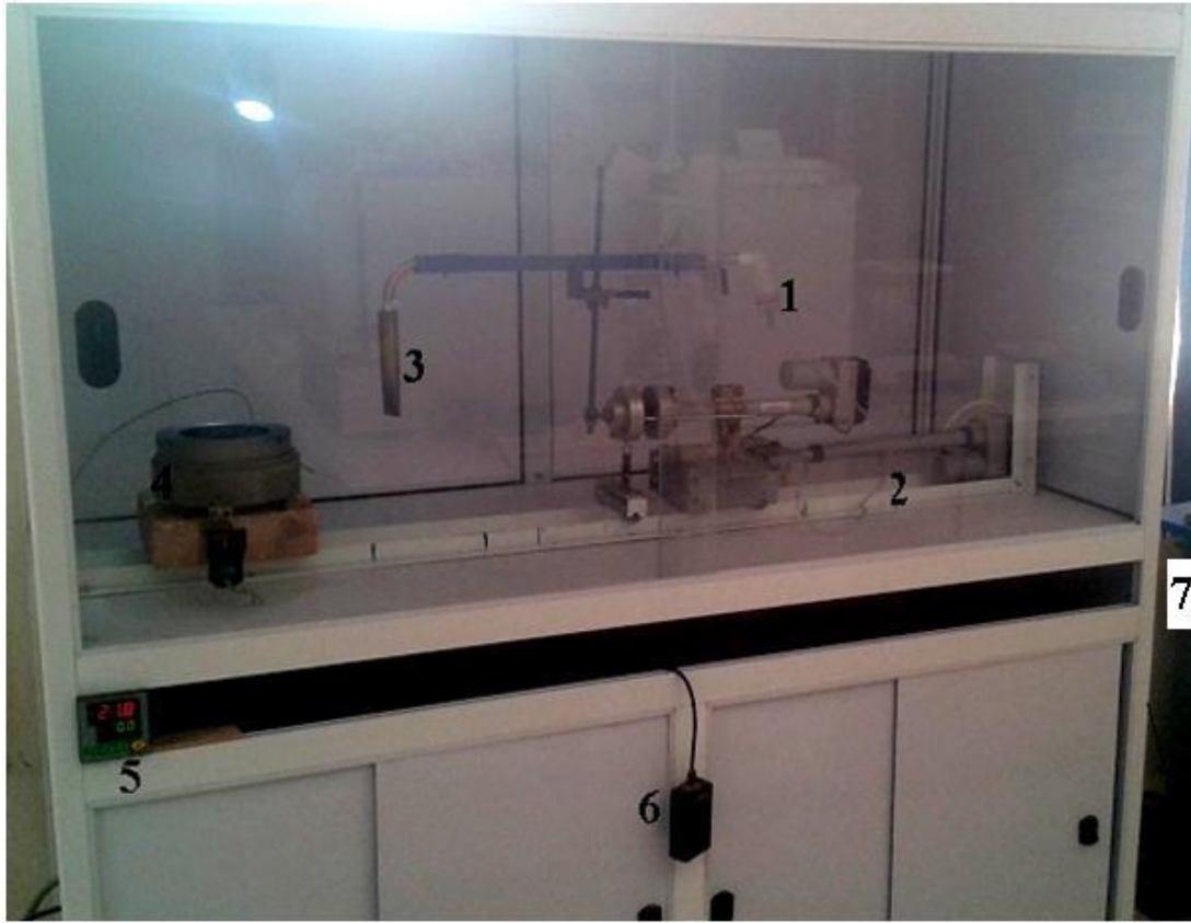
الشكل (6.III): التركيب التجريبي المستخدم لتحضير الطبقات الرقيقة بتقنية رذاذ الانحلال الحراري .
