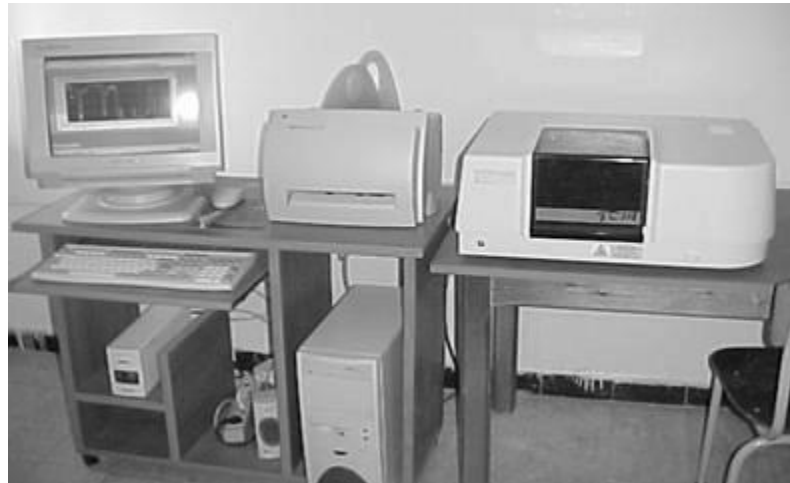
الشكل (5.III): مخطط مطياف الامتصاص ما تحت الأحمر ولواحقه.
