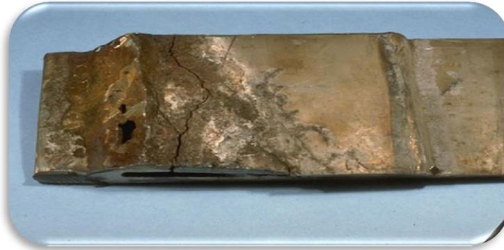
**Figure (I.8) :** *Corrosion sous contrainte d'un assemblage en acier allié soudé (contraintes liées au soudage)*
