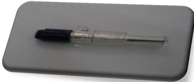
Figure (IV.5):Électrode auxiliaire
