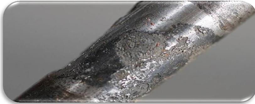
*Figure (I.3): Corrosion inter granulaire dans un tube d'aluminium*
