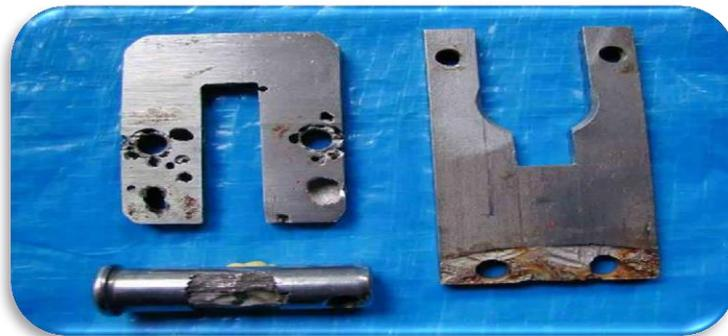
*Figure.(I.4): Pièces d'acier "inoxydable" corrodées par un séjours en eau de mer*
