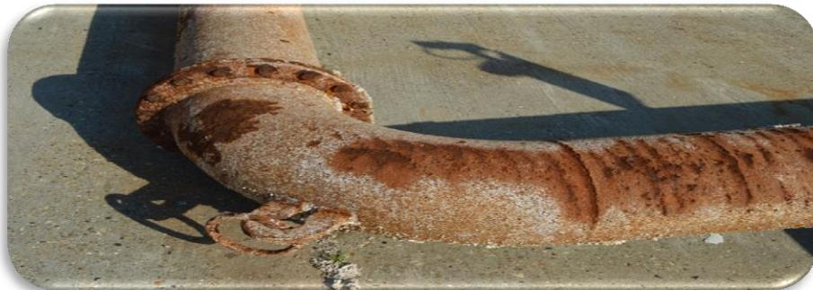
*Figure(I.1): la corrosion uniforme dans une pipe de transport.*
