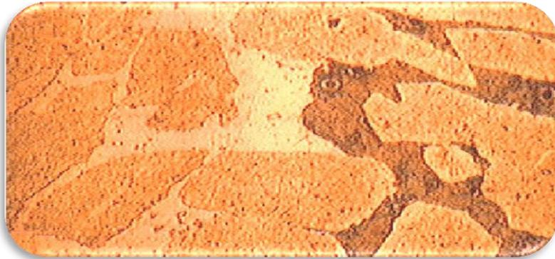
*Figure (I.6) : Coupe métallographique montrant une corrosion sélective d'un laiton*
