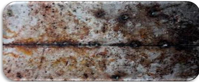
*Figure (I.2) : corrosion par piqûre dans une paroi*
