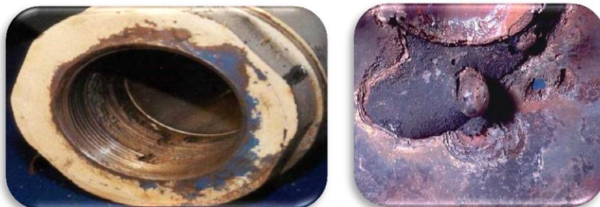
*Figure (I.5): Corrosion galvanique au niveau d'une zone de brasage entre la brasure Cu-P et le tube en cuivre.*
