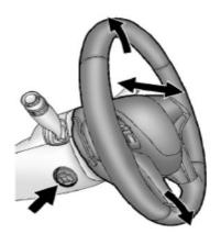
Press the control to move the tilt and telescoping steering wheel up and down or forward and rearward. ضبط مسند الرأس لا تقد السيارة حتى يتم تثبيت مساند الرأس لجميع الركاب وضبطها بشكل صحيح. للحصول على وضع جلوس مريح. قم بتغيير زاوية إمالة ظهر المقعد بأقل قدر مكن مع الحفاظ على ارتفاع المقعد ومساند الرأس في موضعه الصحيح.
