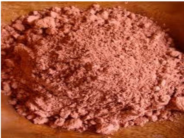
**Figure (10) :** l'argile kaolinite
