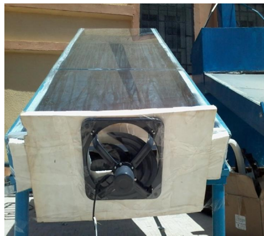
Figure (A.B.9): Ventilateur à l'entrée de capteur
