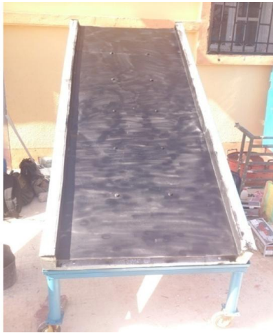
Figure (A.B.6): Peinture de L'absorbeur (noir mate)
