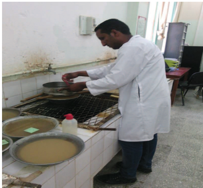
Figure15. l'avage des échantions en granulométrie.
