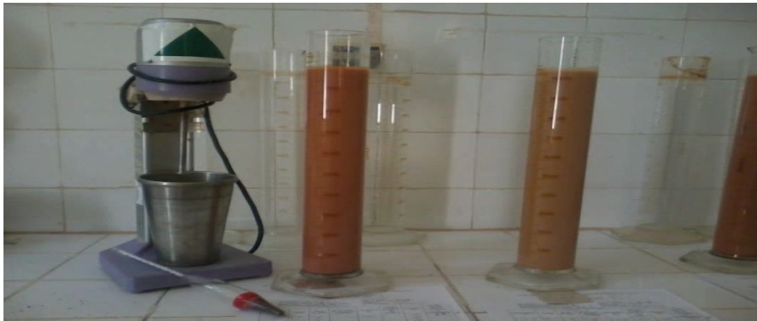
Figure 21. Analyse sédimentométrique des particules fines.
