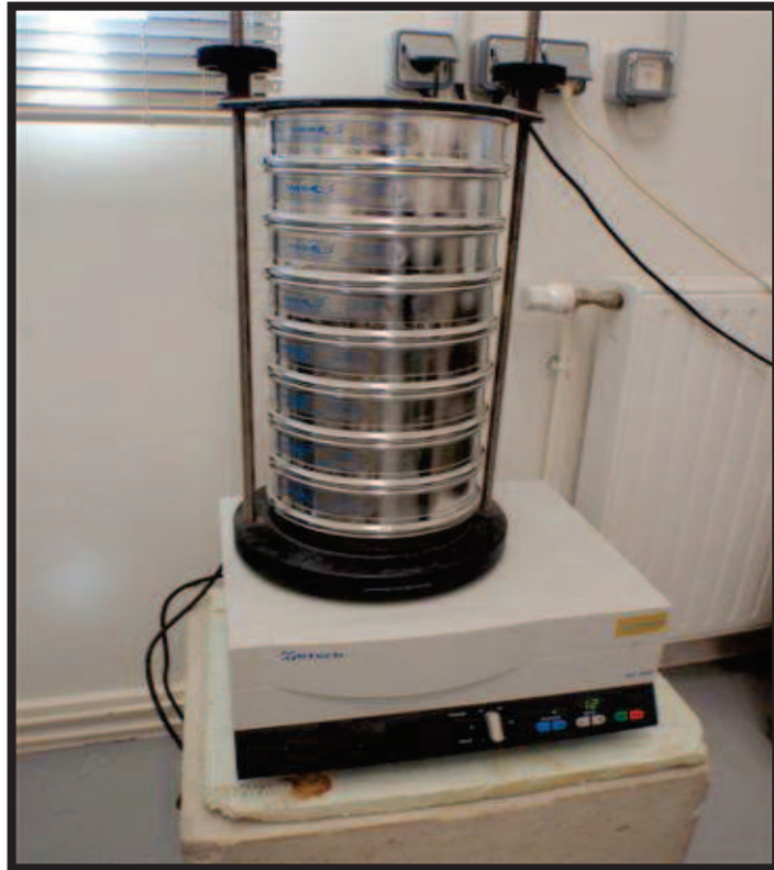
figure 17. Colonne des tamis et tamiseuse
