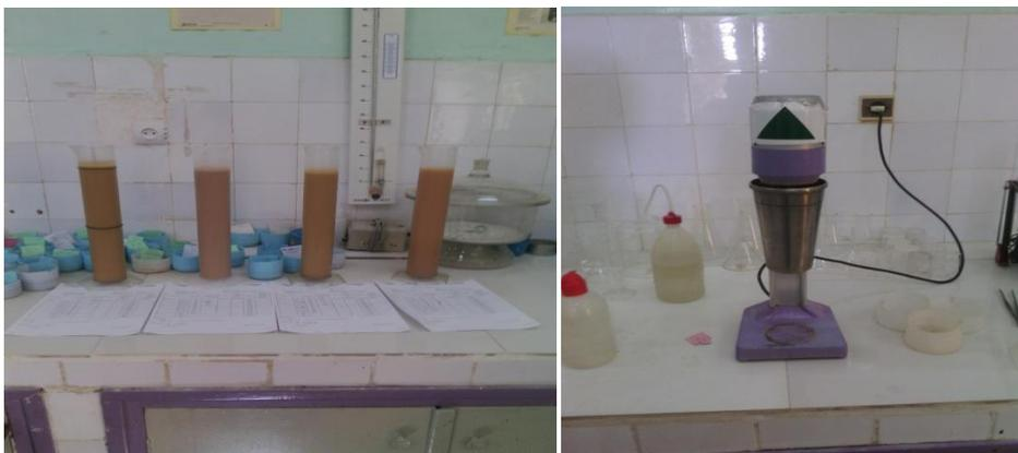
**Fig.26 : Analyse sédimentométrique des particules fines.**
