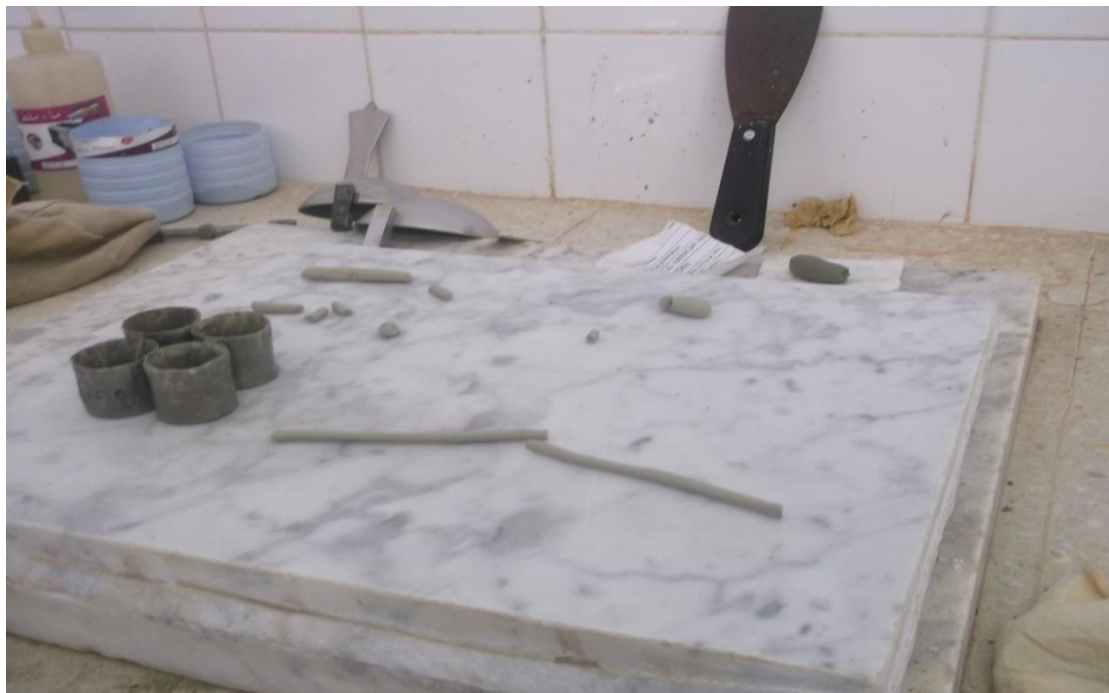
Fig. 11 : La mesure des limites de plasticité des différents échantillons.
