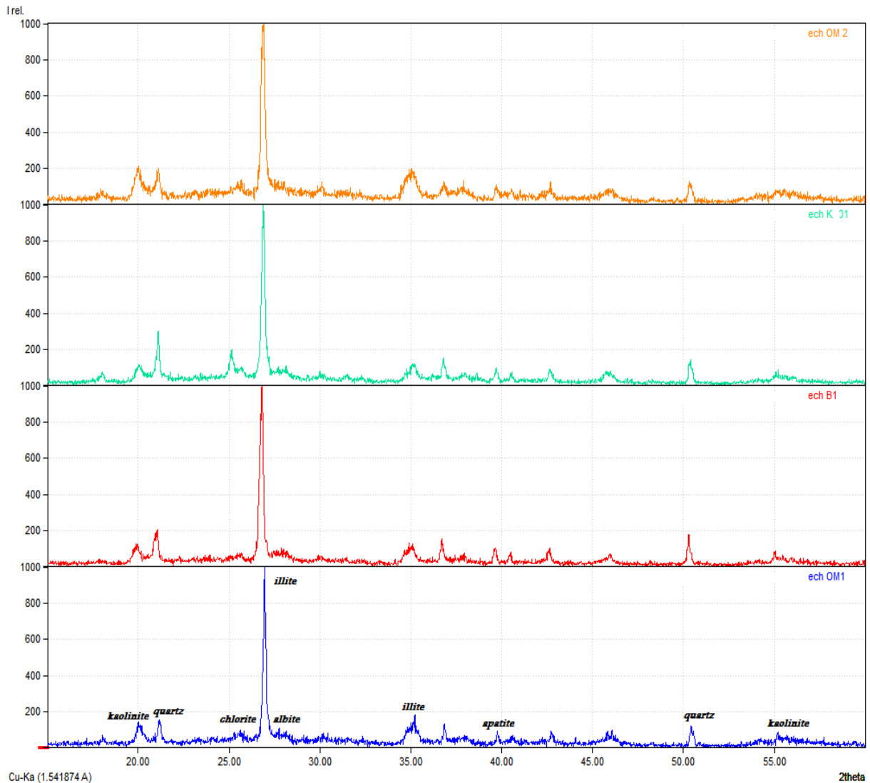
Fig. 27 : Comparaison entre les diffractions des rayons X sur les échantillons (K1 ; B1 ...).
