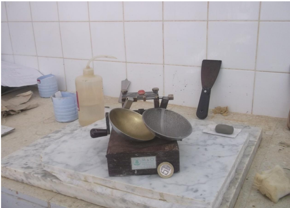
Fig. 10 : Photo montrant l'appareil de casagrande pour déterminer la limite de liquidité.
