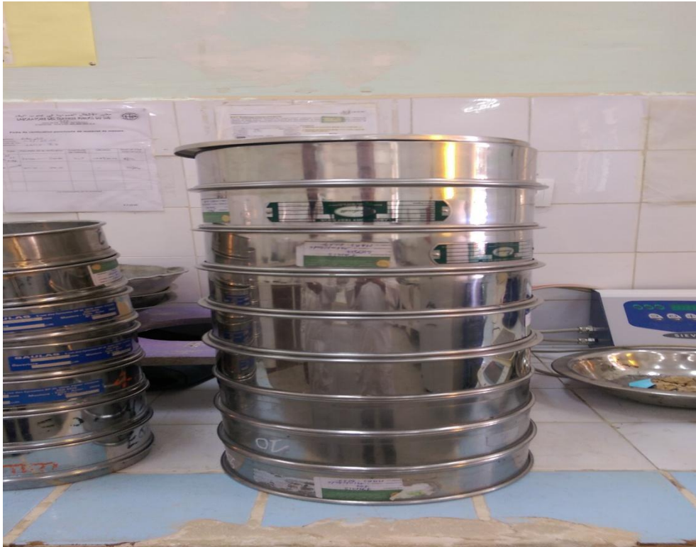
Fig. 05 : Photo montrant le mode opératoire de l'essai de tamisage.
