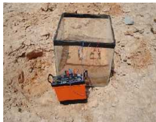
Fig.4 : Cellule et appareil de mesure de résistivité (TERRAMETRE ABEM SAS 1000).
