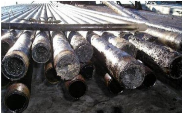
Fig II.7 : Dépôt d'Asphaltène dans les Tubings de Production.
