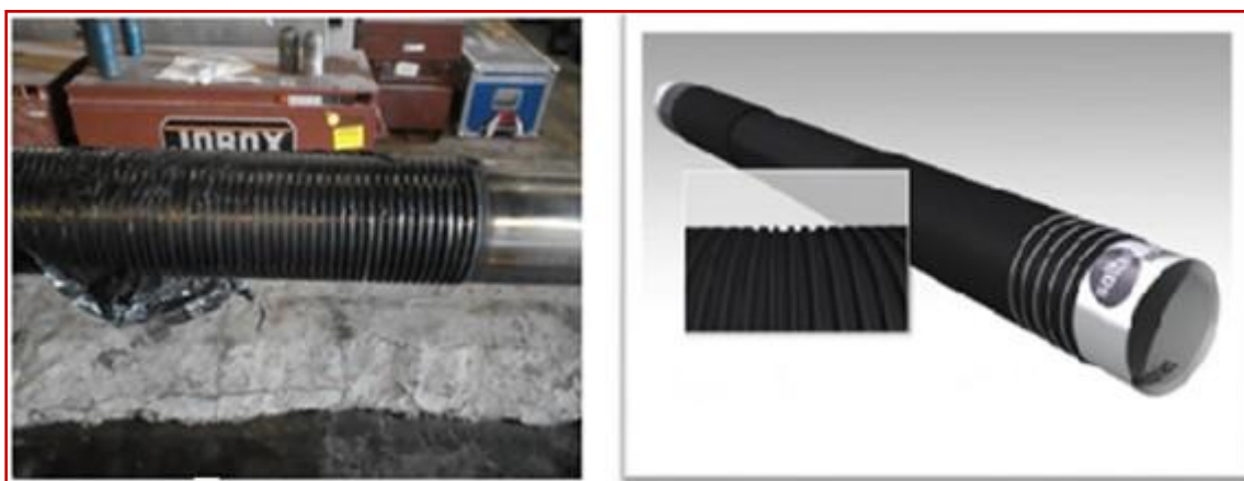
Fig.III-5 : Photo réelle de la partie en caoutchouc du Casing Patch
