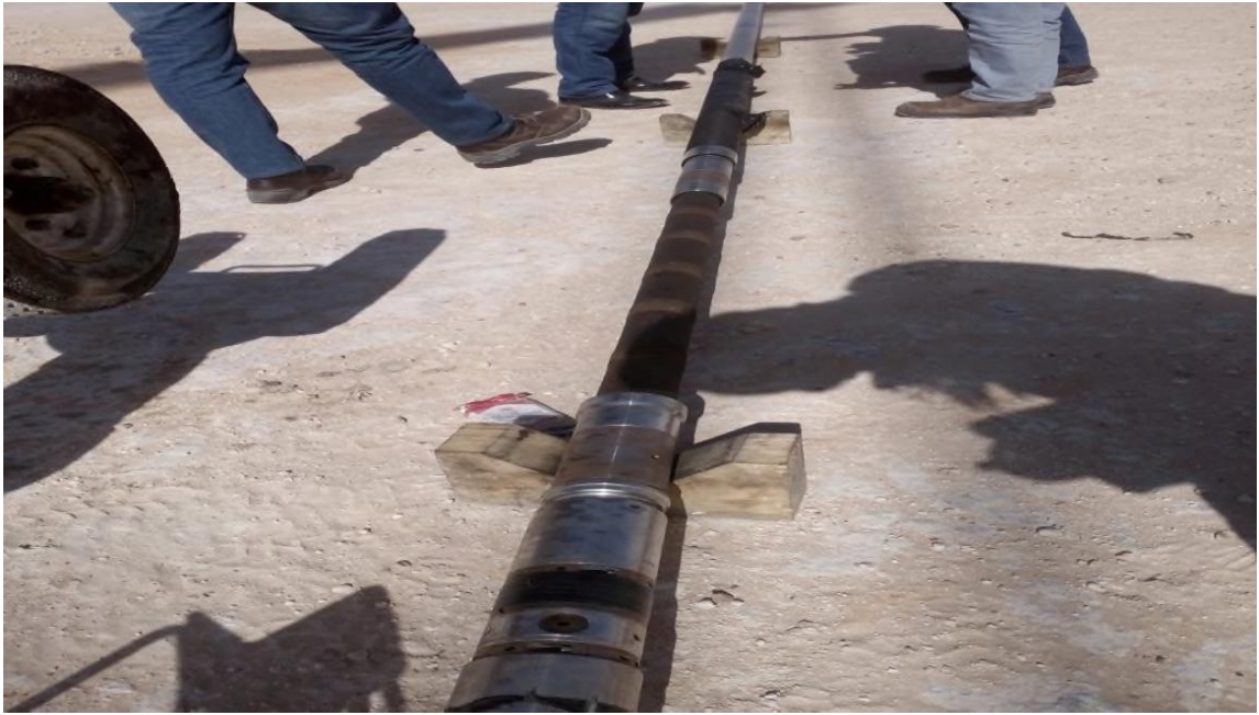
Fig.III-6: l'assemblage de train de CASING PATCH
