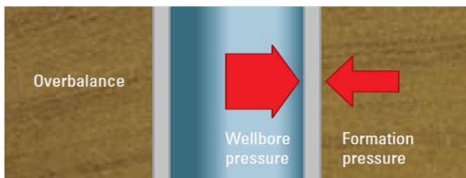
Fig III-6 : Perforation en overbalance
