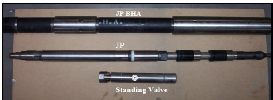
Figure II.13 : Les équipements de fond de Jet Pump libre.
