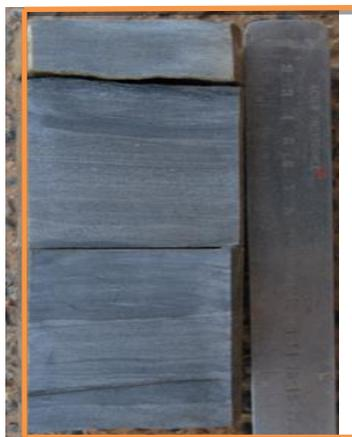
Figure II-6: Silt argilo-micacé. Puits Md103
