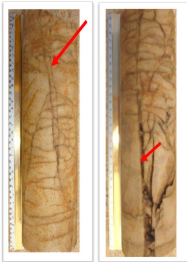
Fig. II.15 : Exemples des fractures ouvertes (carottages des puits ONE321)
