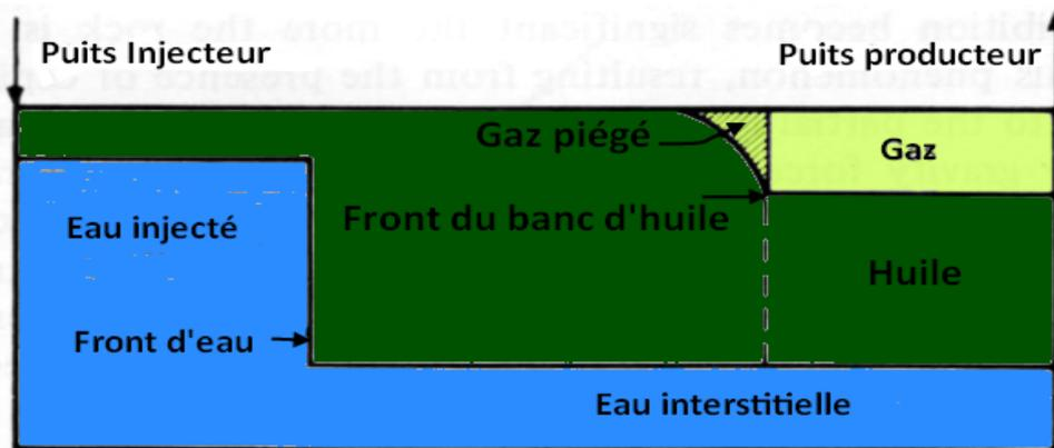
Fig. I.5. Illustration de l'état des fluides dans le réservoir « pendant l'injection d'eau ». [1]
