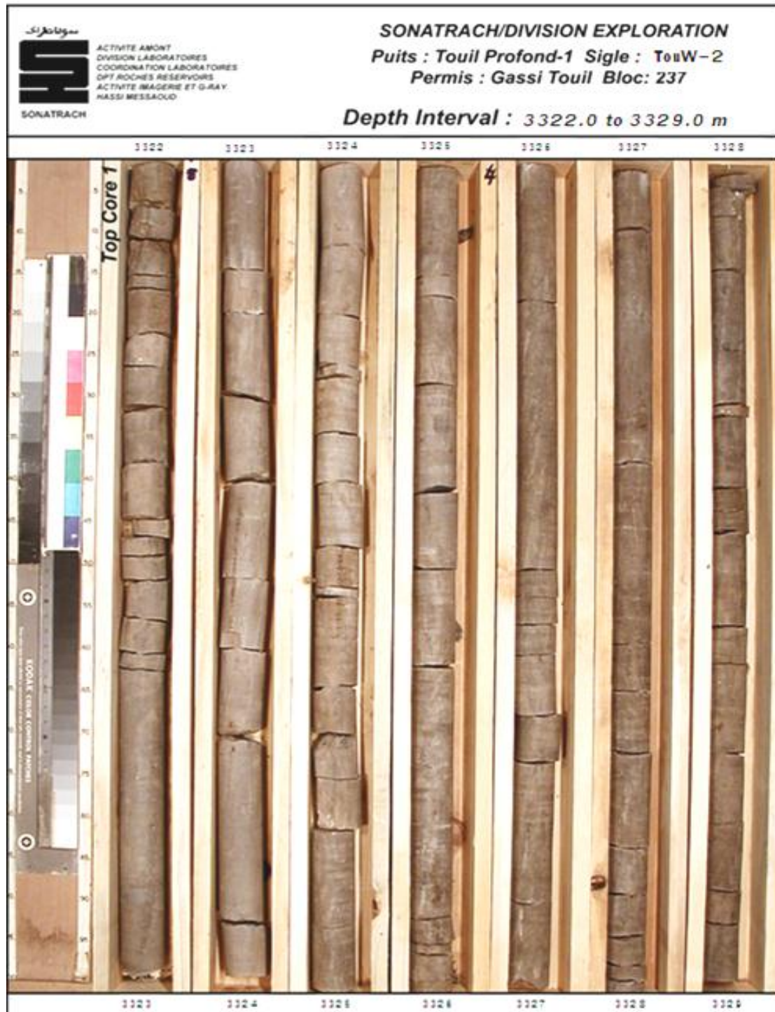
(Fig.10): Carotte dans le réservoir Trias Argileux Gréseux Inferieur du puits TOUW-2(document SONATRACH, 2009).
