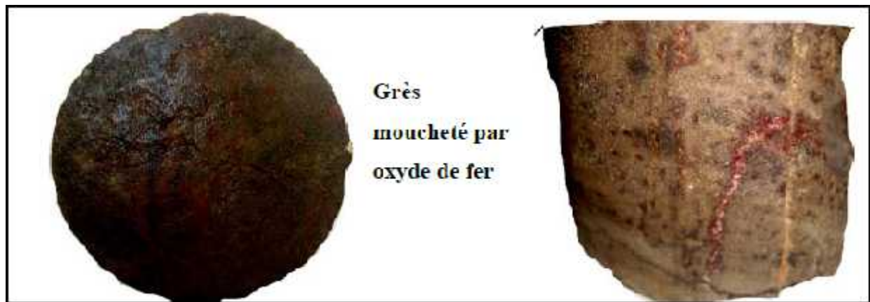
Photo.33 : fissures colmatées par l'oxyde de fer.
