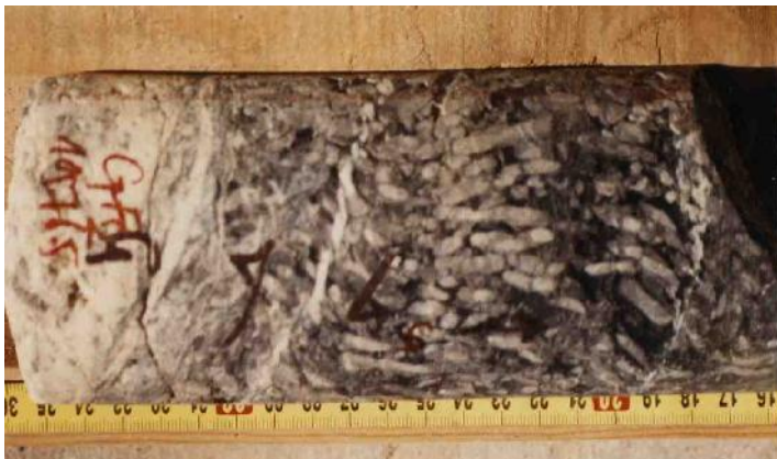
Fig.29 : zone de brèche.
