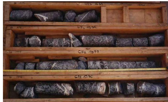
Fig.30 : une faille associée avec des brèches.
