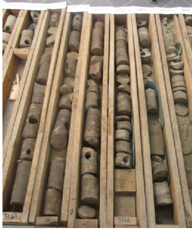
RDC1-bis : 3761m à 3767m Grès du RDC
