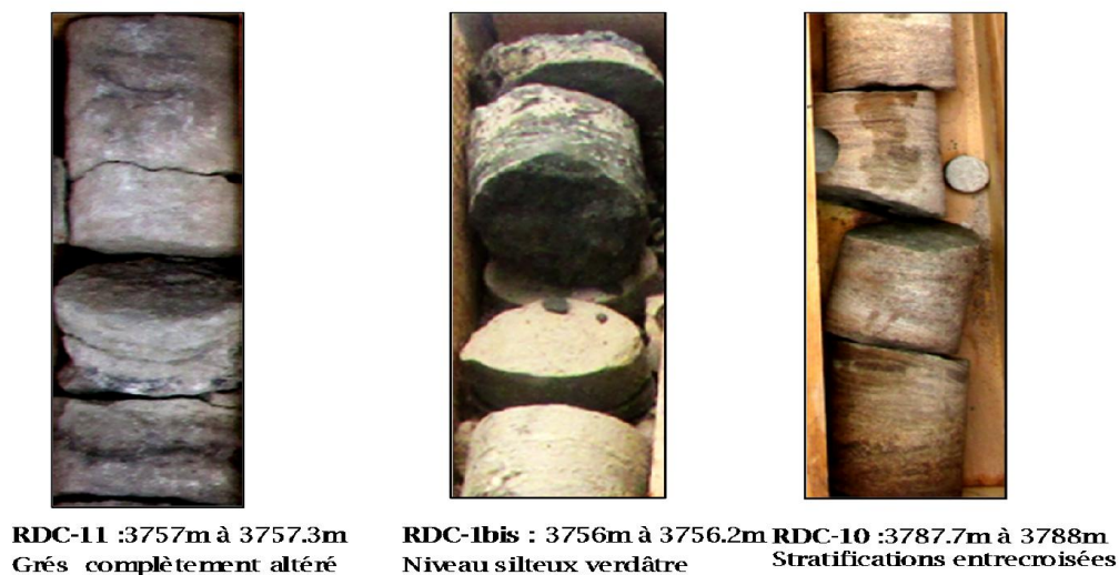
FIG.20 Photos des carottes de Grès du RDC représentent les puits RDC-11, RDC-1bis et RDC-10.
