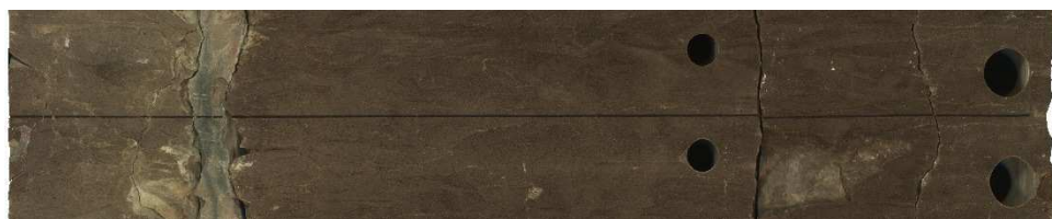
Fig. 81: Carotte n°2 l'intervalle (3407m-3408m)
