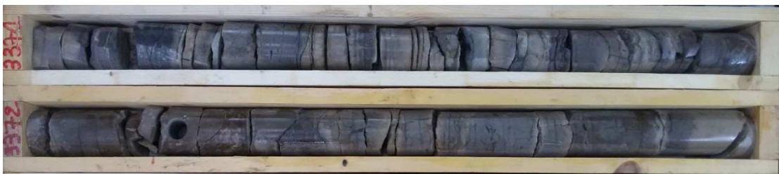
Fig. 13 : Carotte n°1 du puits HGA36 à l'intervalle (3371m-3372m)
