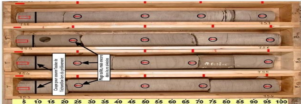
Fig.(19) : La photo montre que chaque 25Cm on fait un plug.
