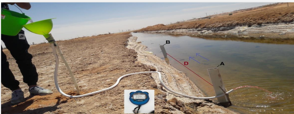
Figure 22: l'injection du traceur dans la section.
