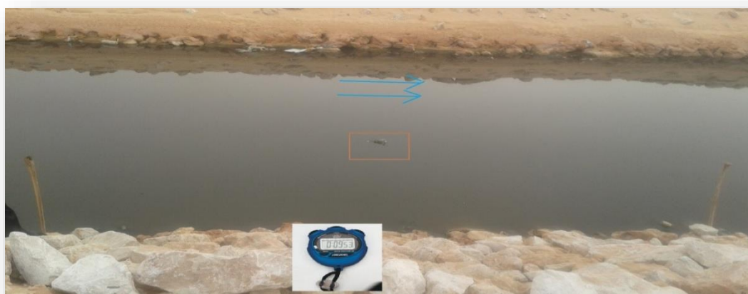
Figure 12: Technique de pose du flotteur
