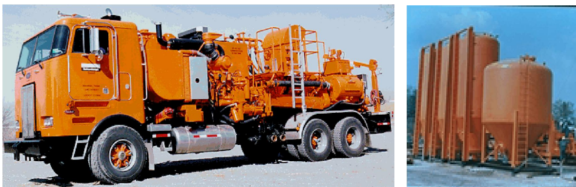
Fig 2.7 : Unité de cimentation et silos de stockage
