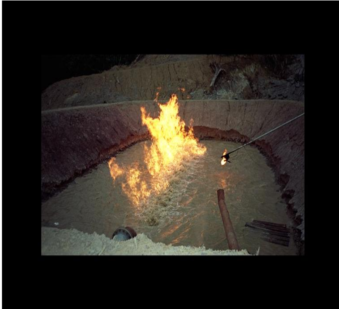
FIG II–19 : La Ligne D'évacuation.
