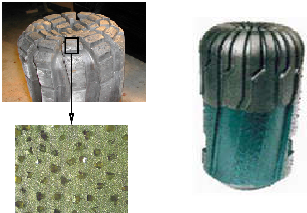
Figure.06: Outil imprégné avec des segments en carbure de tungstène imprégnés de diamants.
