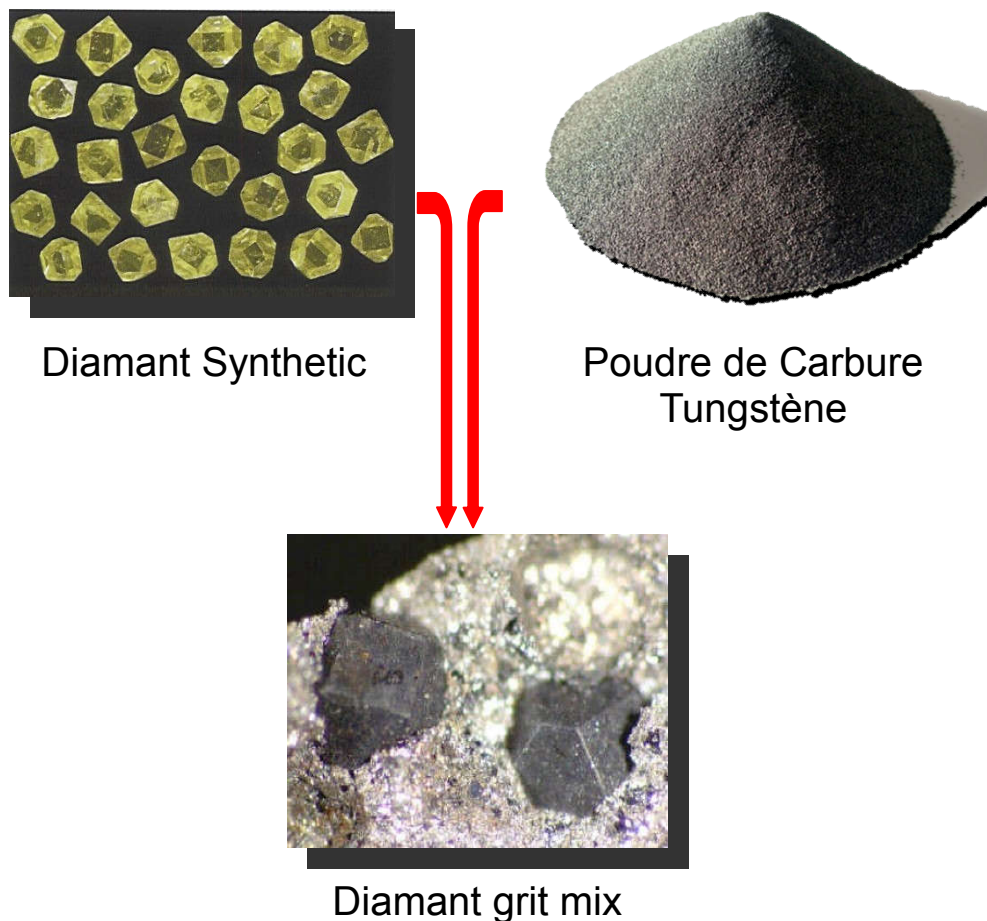
Figure.07: Segments en carbure de tungstène imprégnés de diamants.
