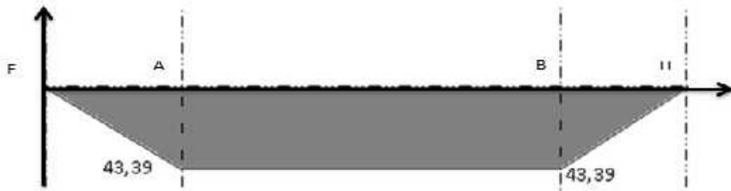
Figure III.8 diagramme du moment fléchissant dans le plan vertical (câble au milieu)
