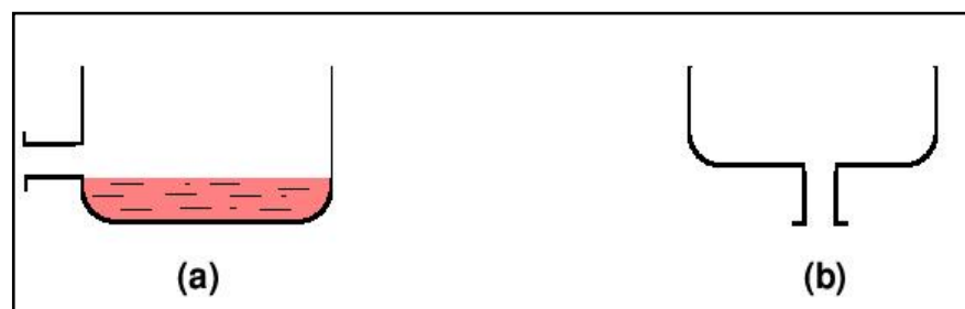
Figure II.1 : Prévention par la forme du récipient. (a) : mauvais. (b) : correct.
