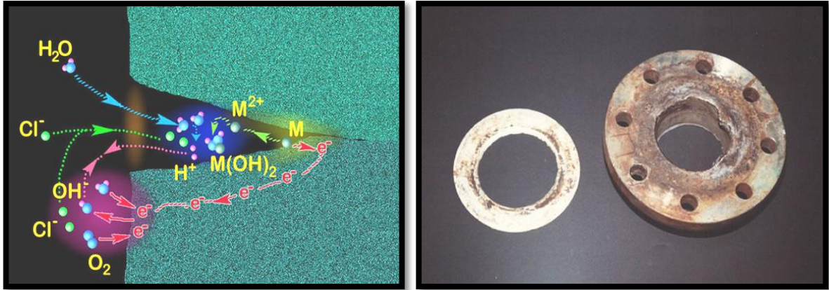
Fig. I.3. Corrosion cavernuse d'un acier allié sous un joint
