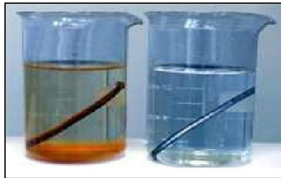
(a) sans inhibiteur de corrosion
