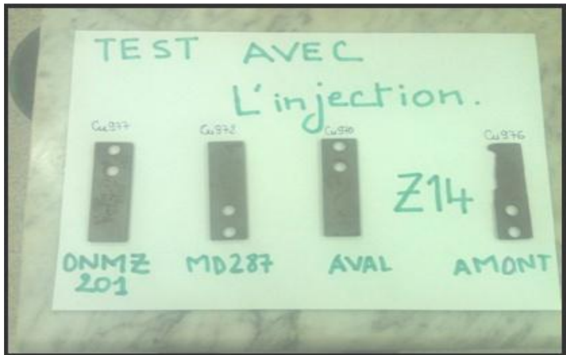
Figure IV.12. Les coupons du test avec l'injection
