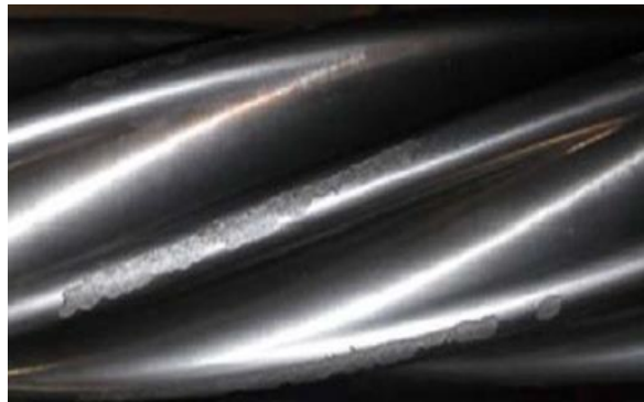
Figure (III.14) : Ecaillage de l'enduit de rotor (coating chipping).
