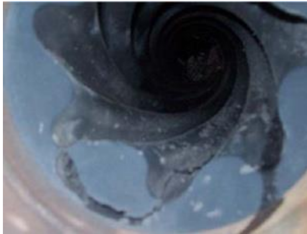
Figure (III.6) : Déchirement (tearing) d'élastomère.
