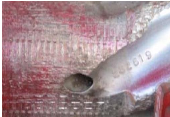
Figure (III.21) : Empreintes sur l'extrémité du corps du rotor.
