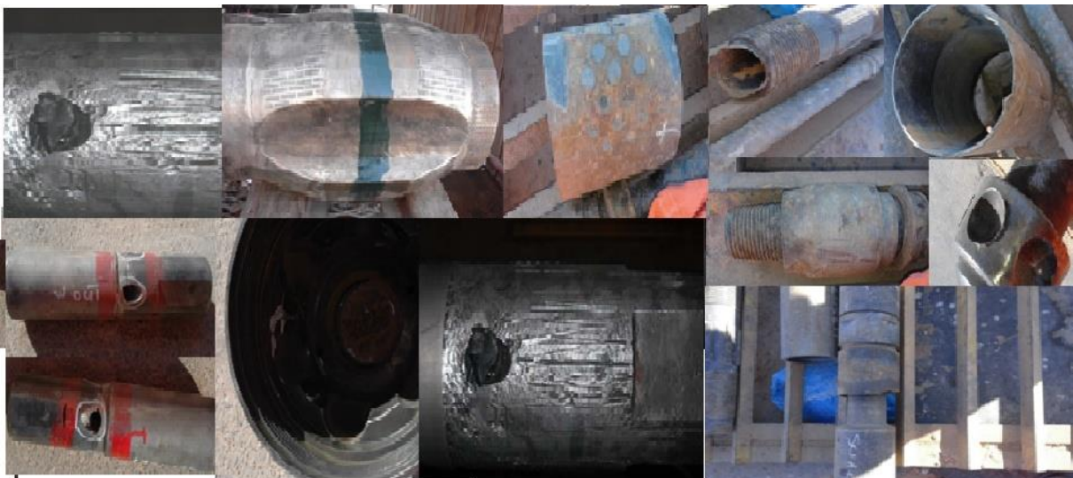
Figure (III.22) : L'endommagement des pièces de PDM.
