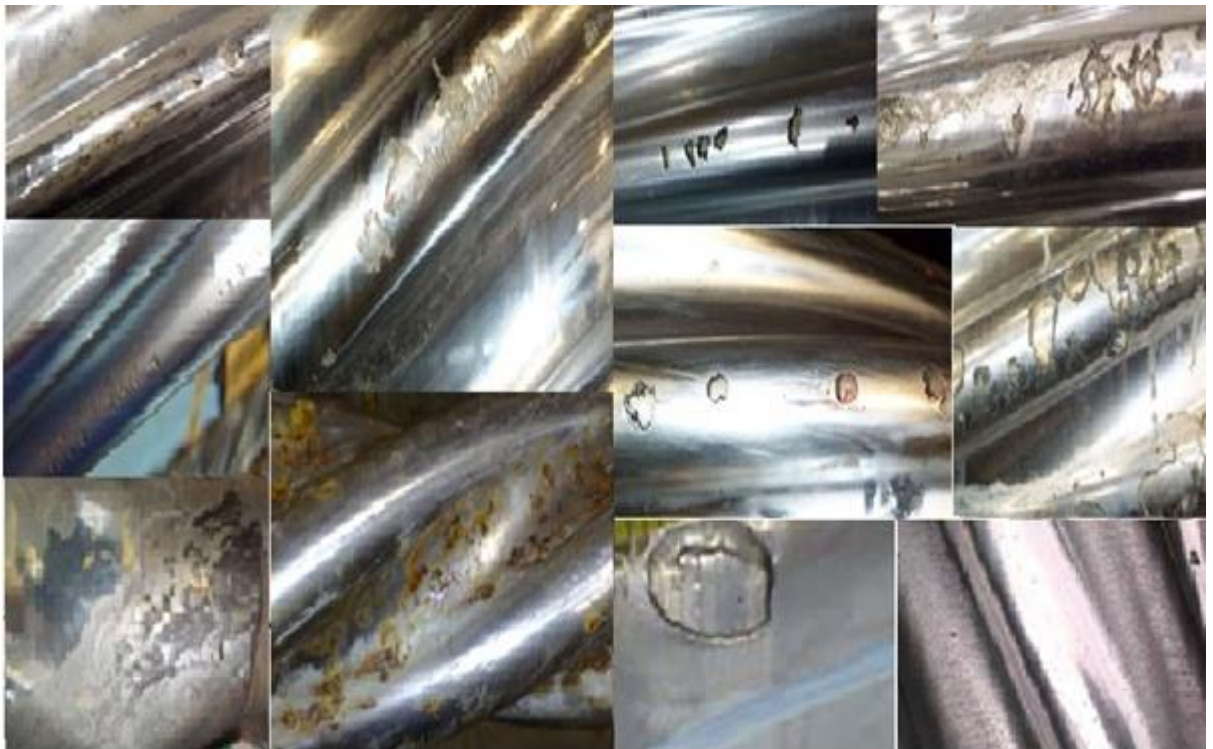
Figure (III.20) : Les piqûes du rotor.
