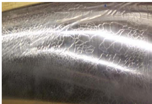
Figure (III.11) : L'effet peau de serpent (snakeskin) sur le rotor.
